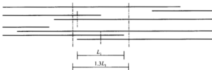
图 6.2.4 钢筋绑扎搭接接头连接区段及接头面积百分率确定方式示意图
